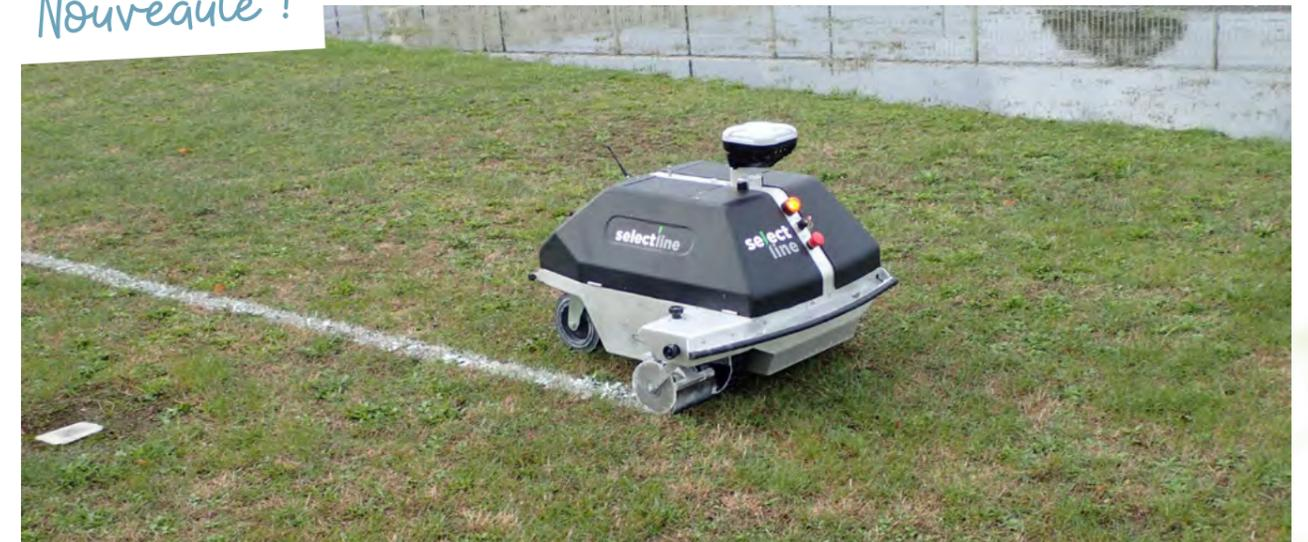
Nous vous proposons, allié à une technologie novatrice : une machine autonome pilotée par GPS et de la peinture très haut de gamme utilisant moins d'eau. C'est une prestation de haute qualité (ligne parfaitement droites et respect des mesures officielles) proposant plusieurs possibilités.
